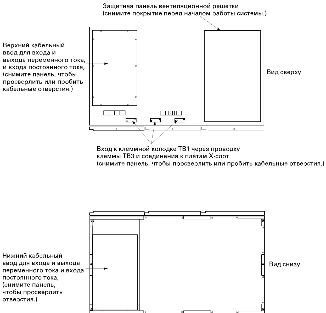
Рис. 3-3. Местоположение входов кабелей
