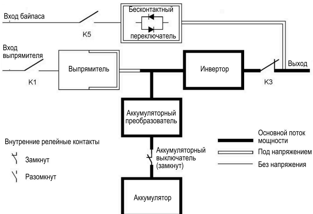
Рис. 2-5: Путь прохождения тока через ИБП в режиме работы от аккумулятора
