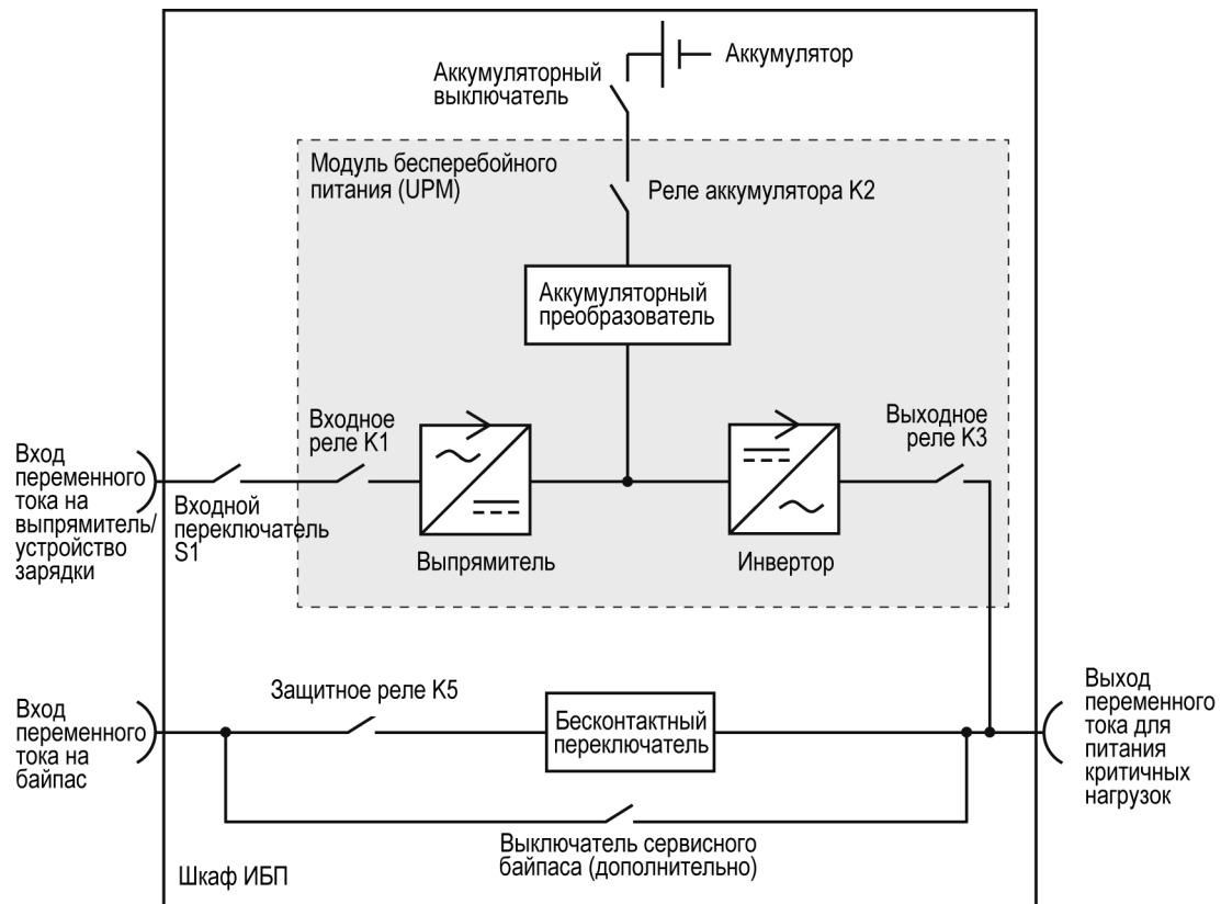
Рис. 2-2: Основные элементы системы ИБП
