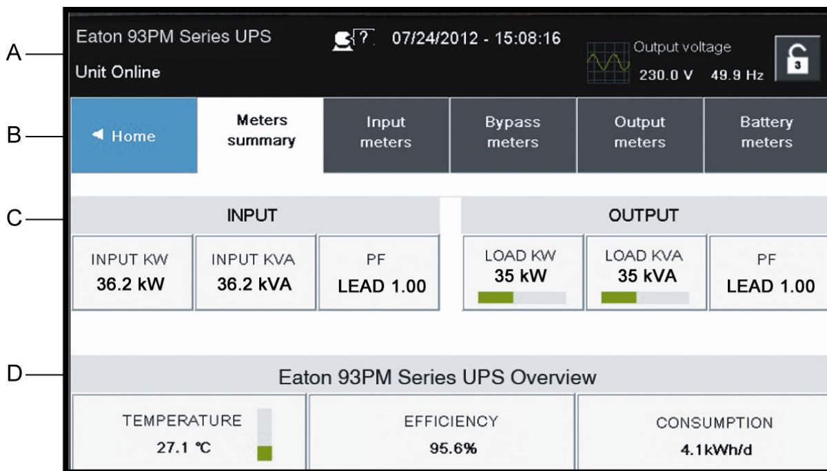
**Рис. 7-1: Компоненты дисплея**
