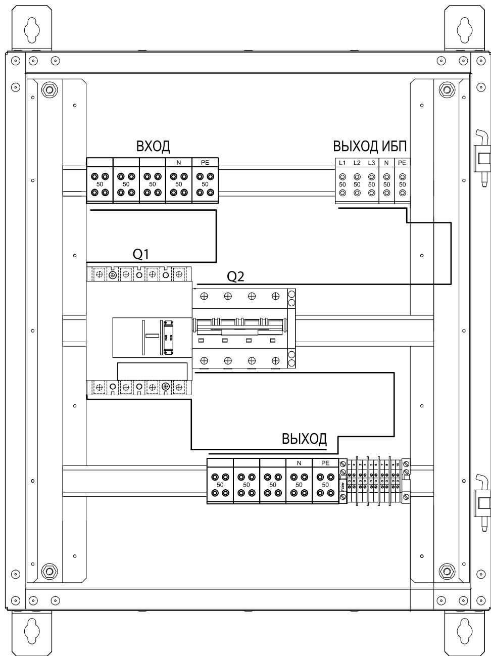
**Рис. 5-3: Сборочный чертеж MBS с двумя выключателями**
