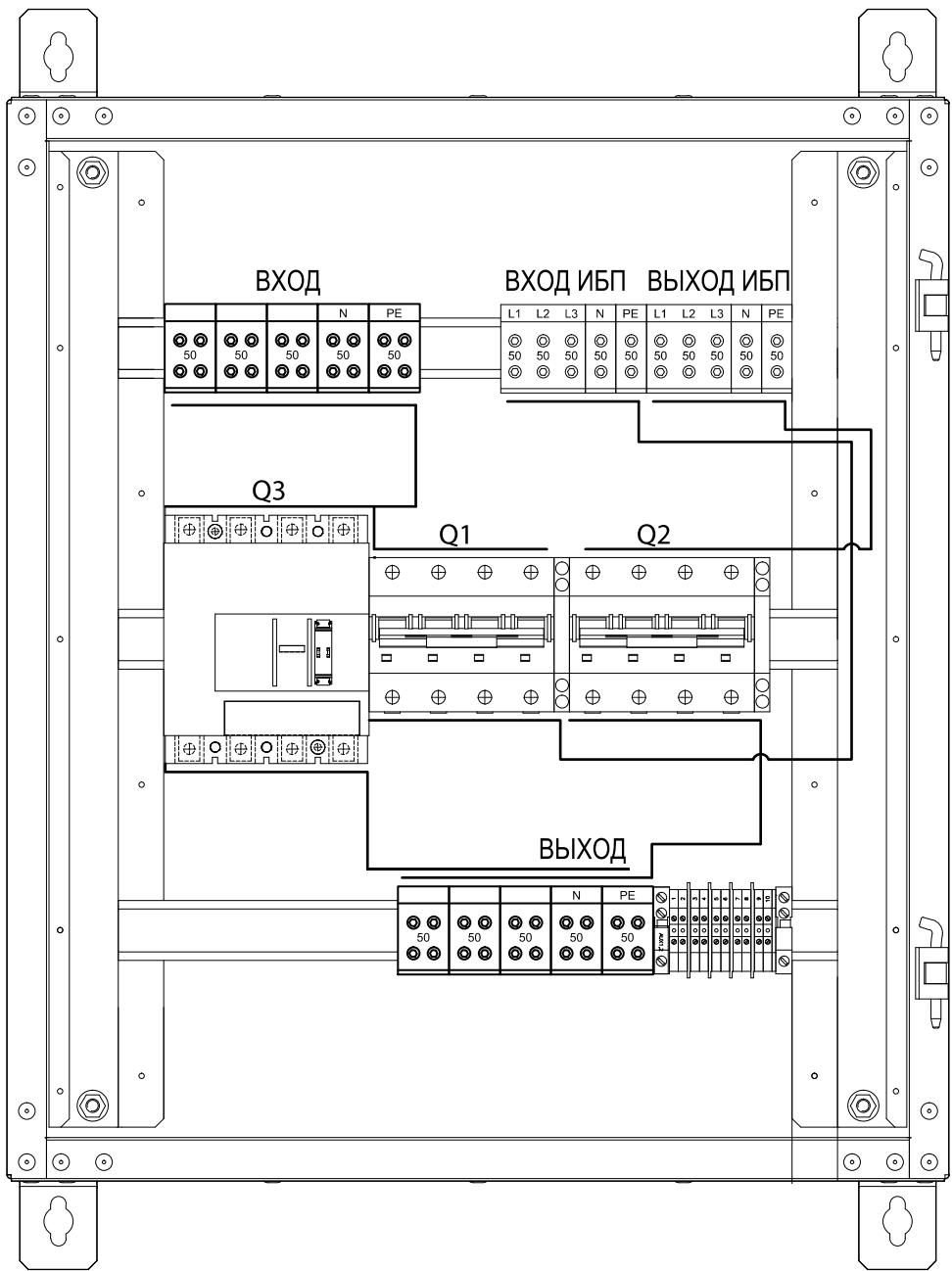
**Рис. 5-4: Сборочный чертеж MBS с тремя выключателями**
