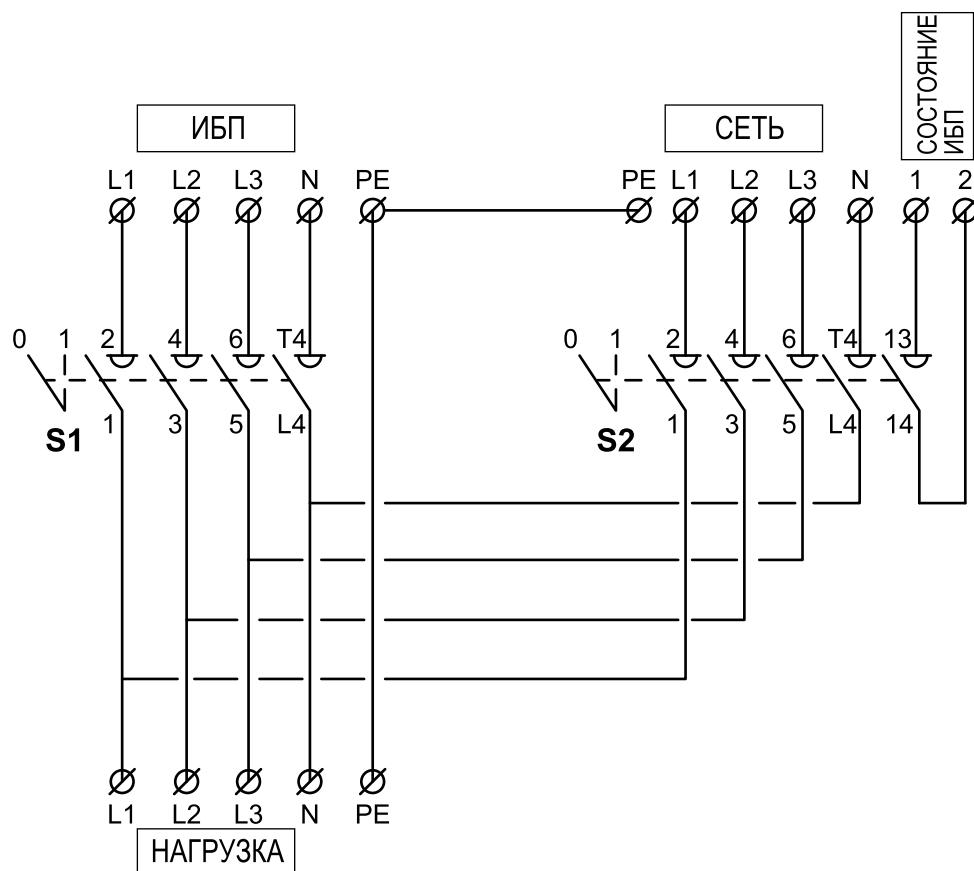
Рис. 5-1: Схема электрических соединений MBS с двумя выключателями
