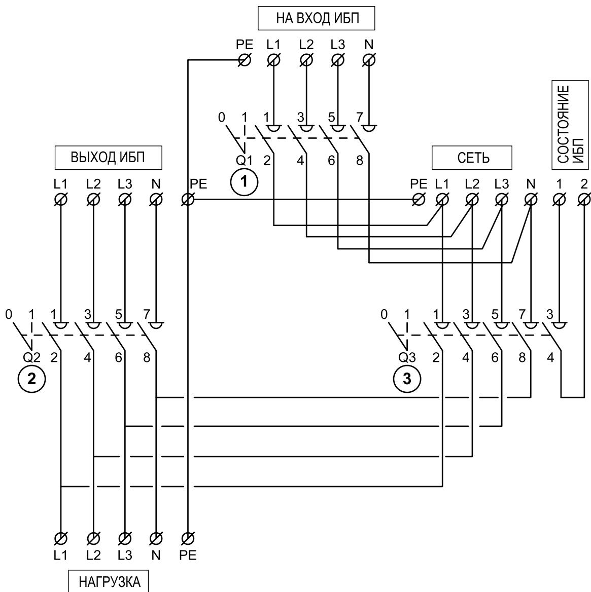
**Рис. 5-2: Схема электрических соединений MBS с тремя выключателями**
